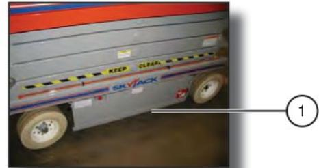
Figure 3-4. Dispositif de protection contre les trous
